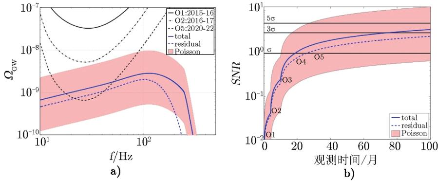
图 5 a) 双黑洞并合产生的随机引力波背景与 AdvLIGO 探测器灵敏度曲线的比较; b) 预计通过 AdvLIGO 探测该引力波背景的信噪比与观测时间长度的关系<sup>[35]</sup>
