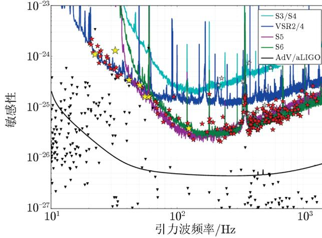
图 3 引力波探测器的噪音曲线和 195 颗临近中子星的引力波上限<sup>[12]</sup>
