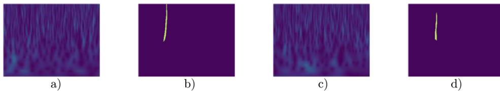
注: a) Hanford 干涉仪时频图; b) Hanford 干涉仪时频图分割结果; c) Livingston 干涉仪时频图; d) Livingston 干涉仪时频图分割结果。
