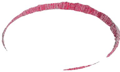
注: 根据高程数据得到的平面剖面图建立山体 CAD 模型, 忽略山体仰角小于  $0^\circ$  的部分, 该模型由 298 块面元组成。
