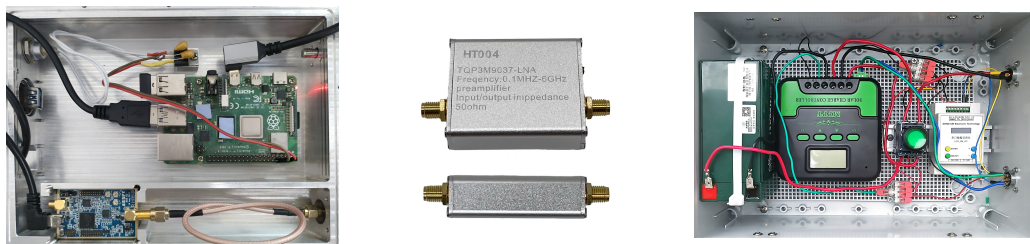
注: 三张小图从左至右依次为: 射频盒内部结构、系统所采用的低噪声放大器、太阳辐照监测系统的内部结构。
